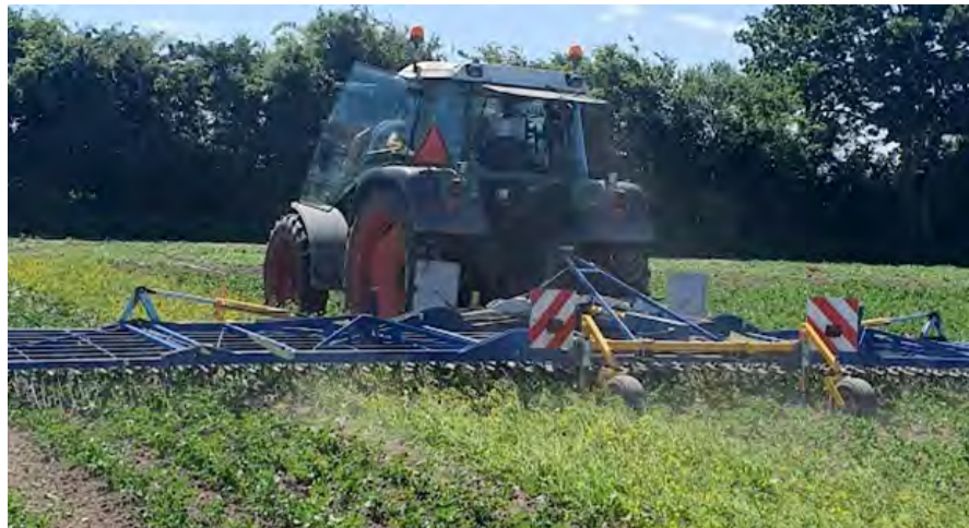
Herfi með stillanlegu átaki eru notuð gegn illgresi í grænmetisræktun, kornrækt og kartöfluræktun.
