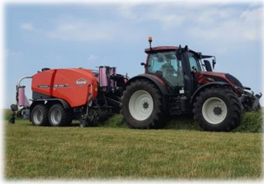
Mynd 2 : Rúllusamstæða sem pressar hey í rúllur og notar belgplast í stað rúllunets.
